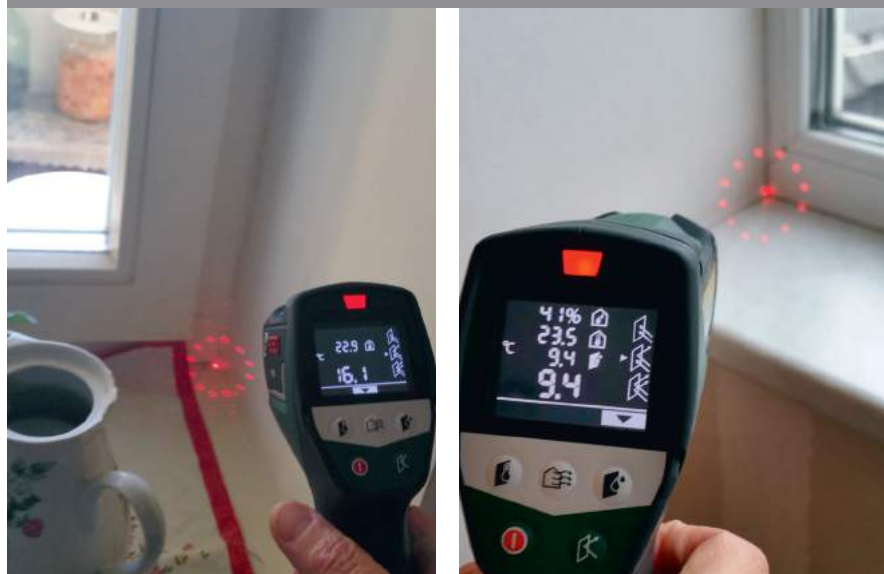
Примеры: результаты измерения температуры поверхности стен
