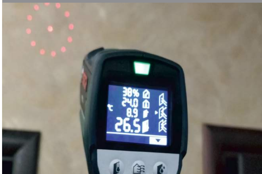
Примеры: результаты измерения температуры поверхности стен
