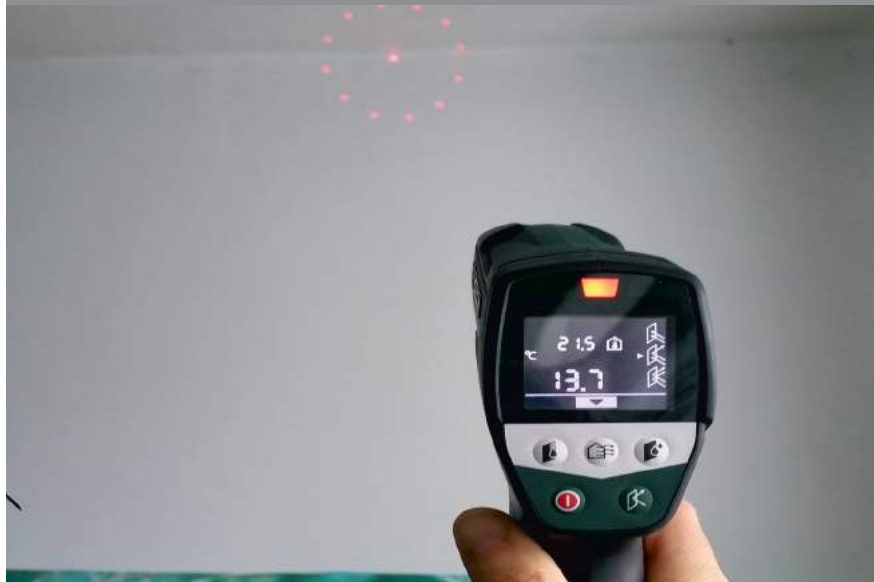
Примеры: результаты измерения температуры поверхности стен
