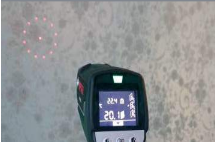
Примеры: результаты измерения температуры поверхности стен
